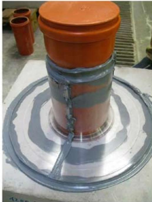
**Bild A1:** Probekörper für den Dichtigkeitstest mit eingebauter Spaltabdichtung „PIPE-SHELL<sup>2a</sup>“
