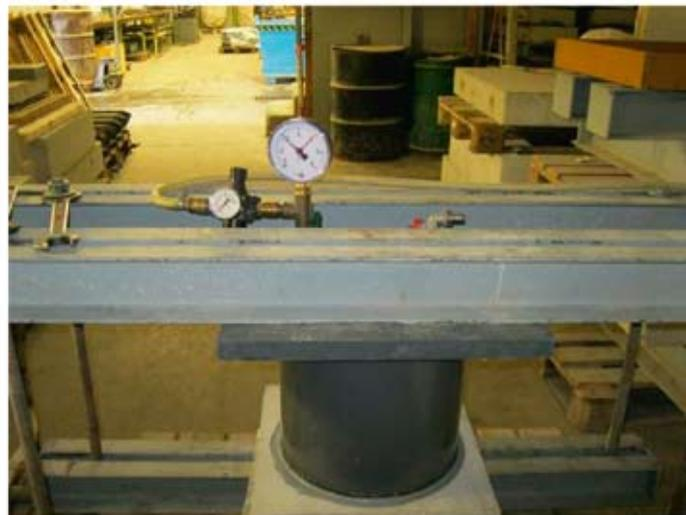
**Bild A2:** Dichtigkeitsprüfung
